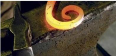
Pour travailler l'acier plus facilement, les forgerons le chauffent à très haute température.
